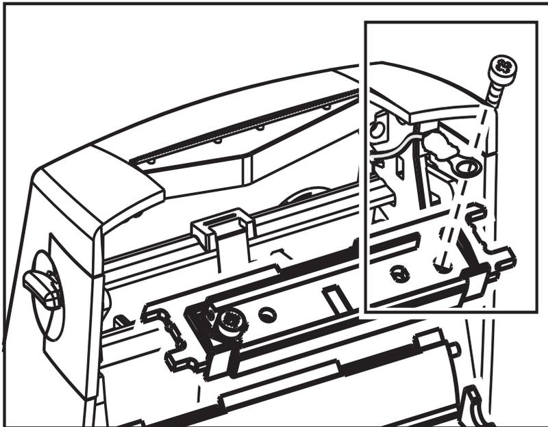
4. Ziehen Sie beide Druckkopfkabel vom linken und rechten Anschluss ab. Verwenden Sie einen Kreuzschraubendreher Nr. 2, um die Schraube zu entfernen, mit der das Erdungskabel befestigt ist.
