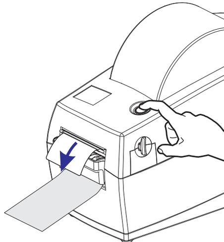
6. Beim Drucken zieht der Drucker das Trägermaterial ab und gibt ein einzelnes Etikett aus. Wenn das Etikett abgezogen wird, druckt der Drucker das nächste Etikett. Hinweis: Wenn Sie den Sensor für abgelöste Etiketten nicht über die entsprechenden Softwarebefehle aktiviert haben, werden die abgezogenen Etiketten vom Drucker gestapelt und ausgeworfen.
