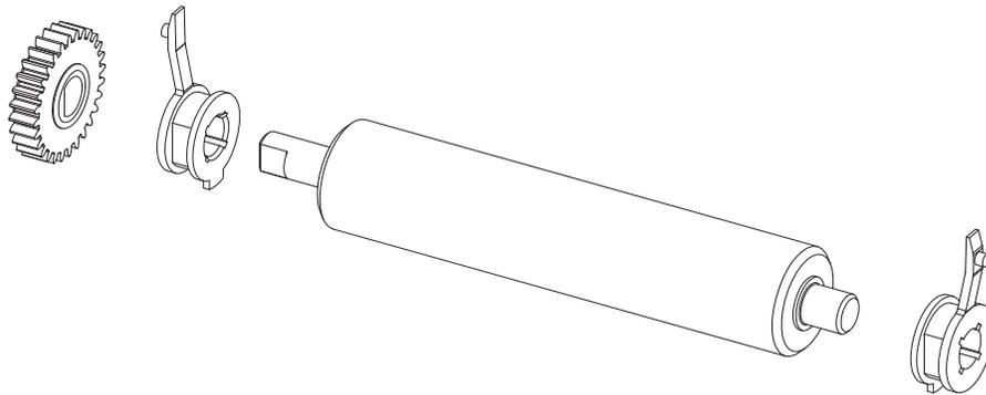
7. Halten Sie die Walze so, dass sich das Zahnrad auf der linken Seite befindet, und setzen Sie sie in den unteren Druckerrahmen ein.
