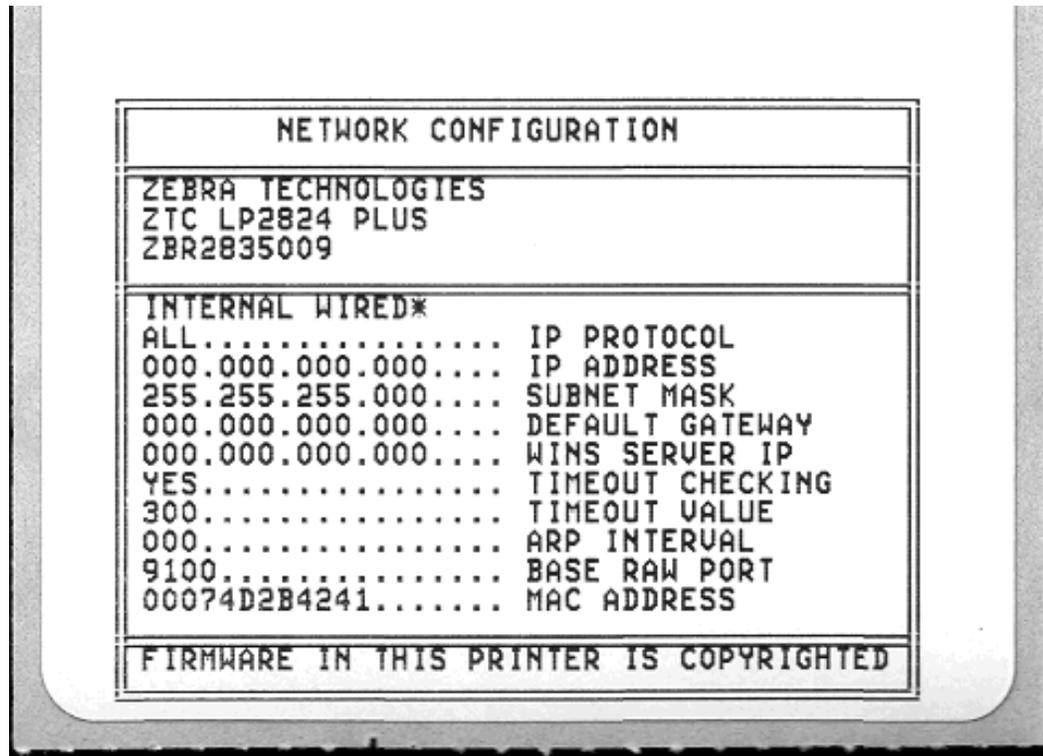
In der unteren Hälfte des Konfigurationsstatusetiketts sind in der Regel einige Netzwerkeinstellungen des Druckers (z. B. die IP-Adresse) aufgeführt.
