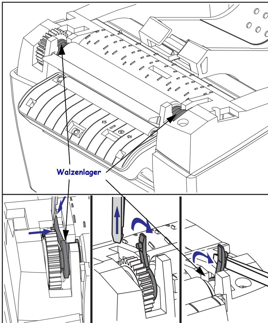
3. Heben Sie die Auflagewalze aus dem unteren Druckerrahmen heraus.
