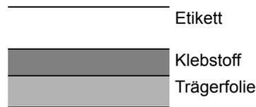
Etiketten bestehen wie in der Abbildung zu sehen aus drei verschiedenen Lagen. Der Klebstoff stellt für das Gerät das größte Risiko dar, denn er wird Druck und Wärme ausgesetzt. Die Trägerfolie trägt das Etikett beim Transport durch das Gerät. Die Kombination der verschiedenen Materialien kann Probleme verursachen.
