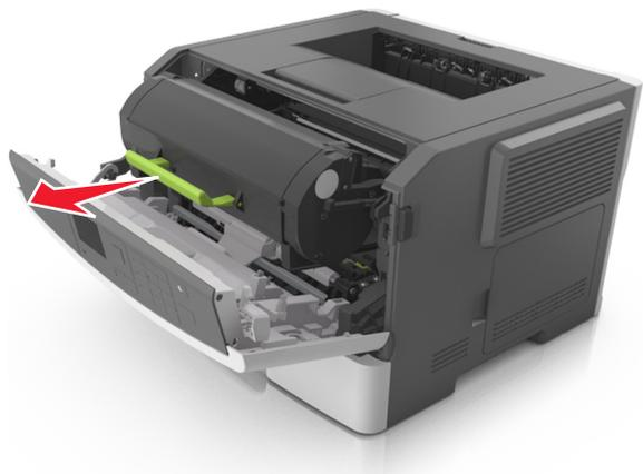
3 Heben Sie den grünen Hebel an und ziehen Sie dann die Belichtungseinheit vollständig aus dem Drucker heraus.
