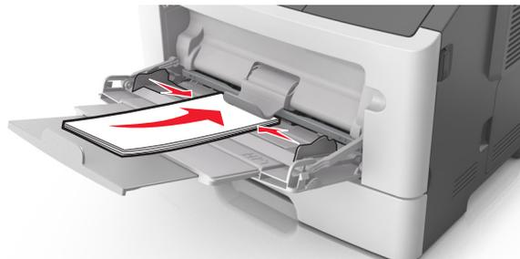
**Warnung - Mögliche Schäden:** Es dürfen keine Briefumschläge mit Briefmarken, Metallklammern, Haken, Fenstern, Fütterung oder selbstklebenden Aufklebern verwendet werden. Durch solche Briefumschläge kann der Drucker schwer beschädigt werden.
