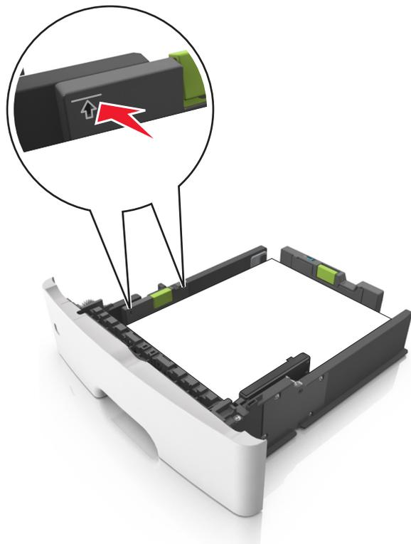
**6** Setzen Sie die Zuführung ein.
