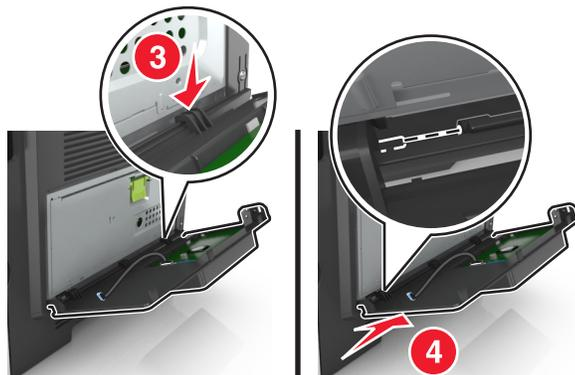
**11** Führen Sie das ISP-Kabel durch die Öffnung in der Schutzabdeckung der Steuerungsplatine.
