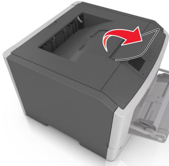
**Hinweis:** Achten Sie beim Umsetzen des Druckers darauf, dass der Papieranschlag geschlossen ist.
