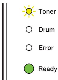
Es steht dann nur noch wenig Toner zur Verfügung. Halten Sie eine neue Tonerkassette bereit, bevor die Meldung zum Ersetzen der Tonerkassette angezeigt wird. Zum Ersetzen der Tonerkassette siehe *Tonerkassette ersetzen* auf Seite 74.
