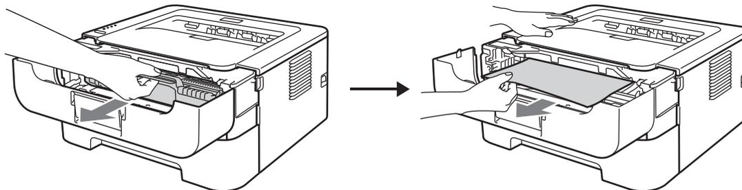
Lässt sich die Trommeleinheit mit der Tonerkassette nicht leicht entfernen, gehen Sie nicht gewaltsam vor, sondern fahren Sie mit Schritt 4 fort.
