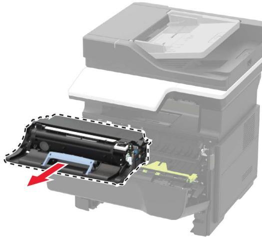
**4** Nehmen Sie die neue Belichtungseinheit aus der Verpackung, und schütteln Sie sie drei Mal, um den Toner zu verteilen.
