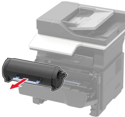
**4** Entfernen Sie die Belichtungseinheit.
