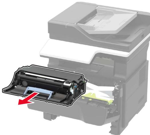
**Warnung—Mögliche Schäden:** Setzen Sie die Belichtungseinheit nicht länger als 10 Minuten direktem Licht aus. Wenn sie zu lange dem Licht ausgesetzt ist, kann dies zu Problemen mit der Druckqualität führen.
