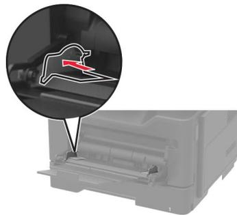
3 Biegen Sie das Papier vor dem Einlegen in beide Richtungen, fächern Sie es auf, und gleichen Sie die Kanten an.
