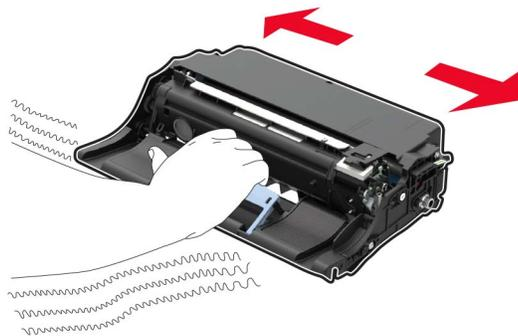
**Warnung—Mögliche Schäden:** Setzen Sie die Belichtungseinheit nicht länger als 10 Minuten direktem Licht aus. Wenn sie zu lange dem Licht ausgesetzt ist, kann dies zu Problemen mit der Druckqualität führen.
