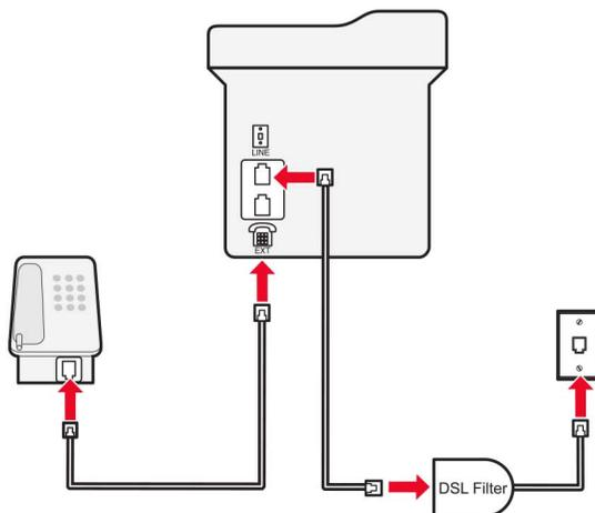
Durch DSL wird Ihre normale Telefonleitung in zwei Kanäle unterteilt: Sprache und Internet. Telefon- und Faxsignale nutzen den Sprachkanal, während Internet-Signale den anderen Kanal verwenden.
