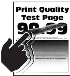
**Hinweis:** Drucken Sie die Testseiten für Druckqualität aus, bevor Sie das Problem beheben. Gehen Sie an der Bedieneinheit zu **Einstellungen > Fehlerbehebung > Testseiten für Druckqualität**. Drücken Sie bei Druckermodellen ohne Touchscreen **OK**, um durch die Einstellungen zu navigieren.
