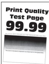
**Hinweis:** Drucken Sie die Testseiten für Druckqualität aus, bevor Sie das Problem beheben. Gehen Sie an der Bedienerkonsole zu **Einstellungen > Fehlerbehebung > Testseiten für Druckqualität**. Drücken Sie bei Druckermodellen ohne Touchscreen
