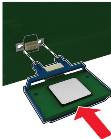
**Hinweis:** Der Steckverbinder auf der Karte muss über die gesamte Länge bündig an der Controller-Platine anliegen.
