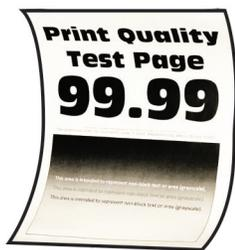
**Hinweis:** Drucken Sie die Testseiten für Druckqualität aus, bevor Sie das Problem beheben. Gehen Sie an der Bedieneinheit zu **Einstellungen > Fehlerbehebung > Testseiten für Druckqualität**. Drücken Sie bei Druckermodellen ohne Touchscreen **OK**, um durch die Einstellungen zu navigieren.
