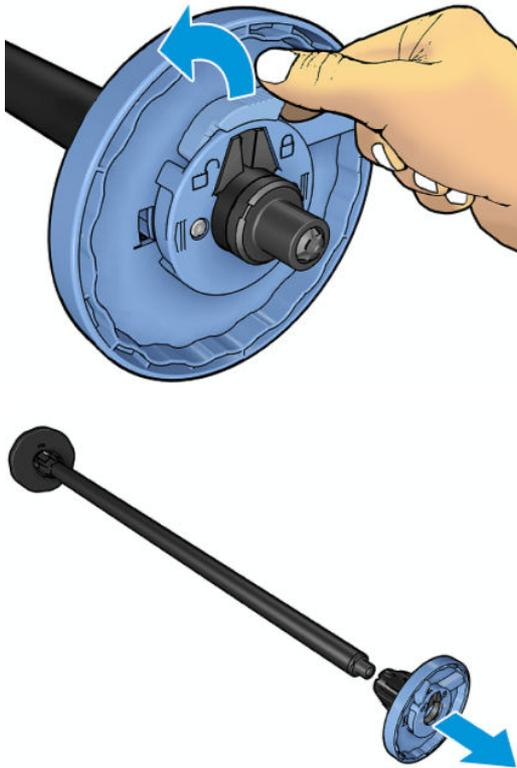
4. Wenn sich bereits eine Rolle oder ein Kern auf der Spindel befindet, entfernen Sie diese.
