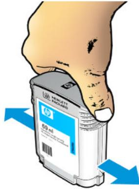
2. Packen Sie die Tintenpatrone aus, und suchen Sie nach dem Etikett mit der Tintenfarbe. Vergewissern Sie sich, dass der Buchstabe bzw. die Buchstaben (in den vorliegenden Abbildungen „M“ für Magenta), mit dem der leere Schacht gekennzeichnet ist, mit der Buchstabenkennung auf dem Patronenetikett übereinstimmt.
