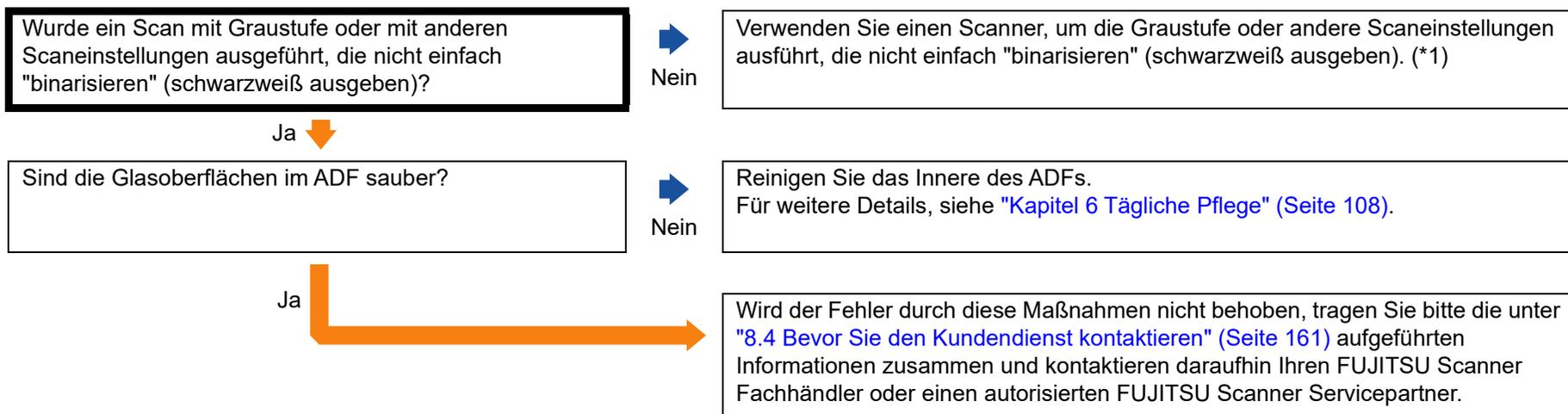
\*1: Die Bildqualität kann sich erheblich von Original unterscheiden, wenn Sie das Foto (oder Bild) einfach binarisieren (schwarzweiß ausgeben). Verwenden Sie wenn möglich einen Scanner, um die Graustufe oder andere Scaneinstellungen zu konfigurieren, die nicht einfach "binarisieren" (schwarzweiß ausgeben) und führen dann einen Scan aus.
