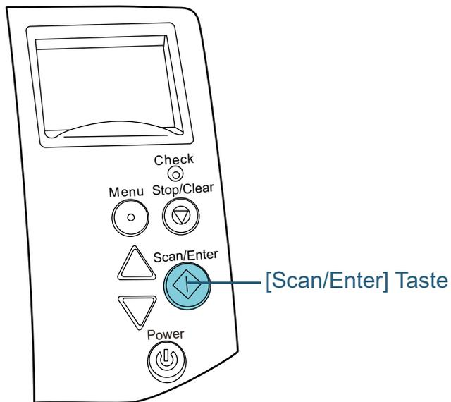
Wenn Sie die [Scan/Enter] Taste drücken, drehen sich die Zuführungs- und Ausgaberrollen gleichzeitig. Geben Sie Acht, die Rollen nicht zu berühren, während diese gedreht werden.
