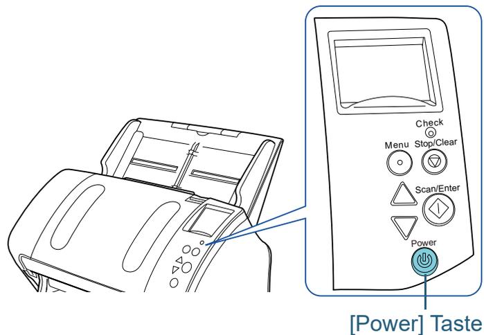
⇒ Der Scanner wird ausgeschaltet und die [Power] Taste erlischt.
