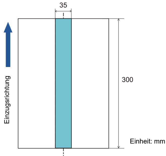
Die Mehrfacheinzugserkennung wird nur für die hellblau dargestellten Bereiche ausgeführt.
