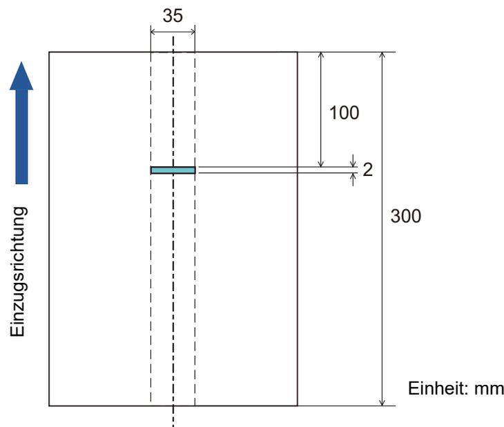
Da der Erkennungsumfang (Länge) kleiner ist als 5 mm, können Mehrfacheinzüge nicht korrekt erkannt werden.
